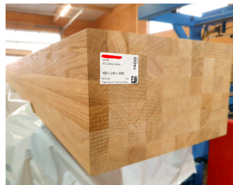
Einer der ersten produzierten Fagus-Träger aus Stabschichtholz Eiche.
