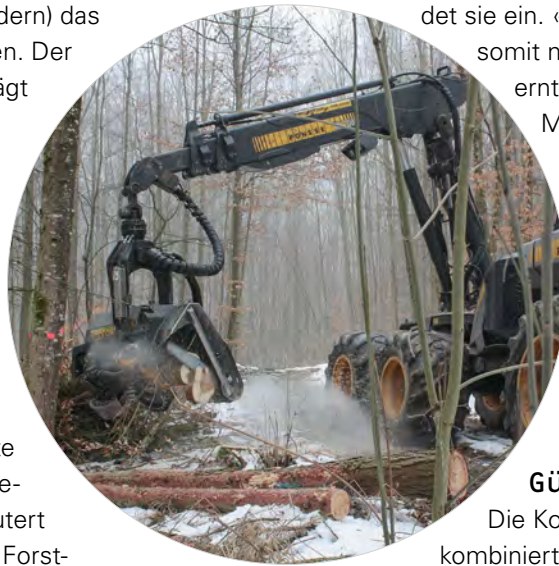
Der Vollernter erlaubt, Holz effizient und bodenschonend dem Wald zu entnehmen.
