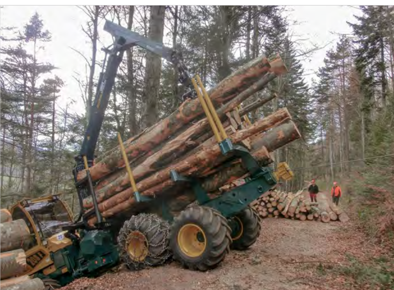
Der Forwarder mit Traktionshilfswinde ist im befahrbaren steilen Gelände besonders effizient.
