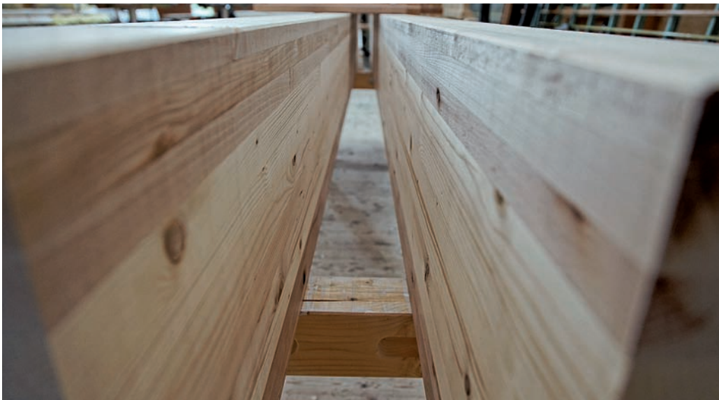
Buche kann Stahl ersetzen: Brettschichtholz für schlanke Konstruktionen im Hochleistungsholzbau
