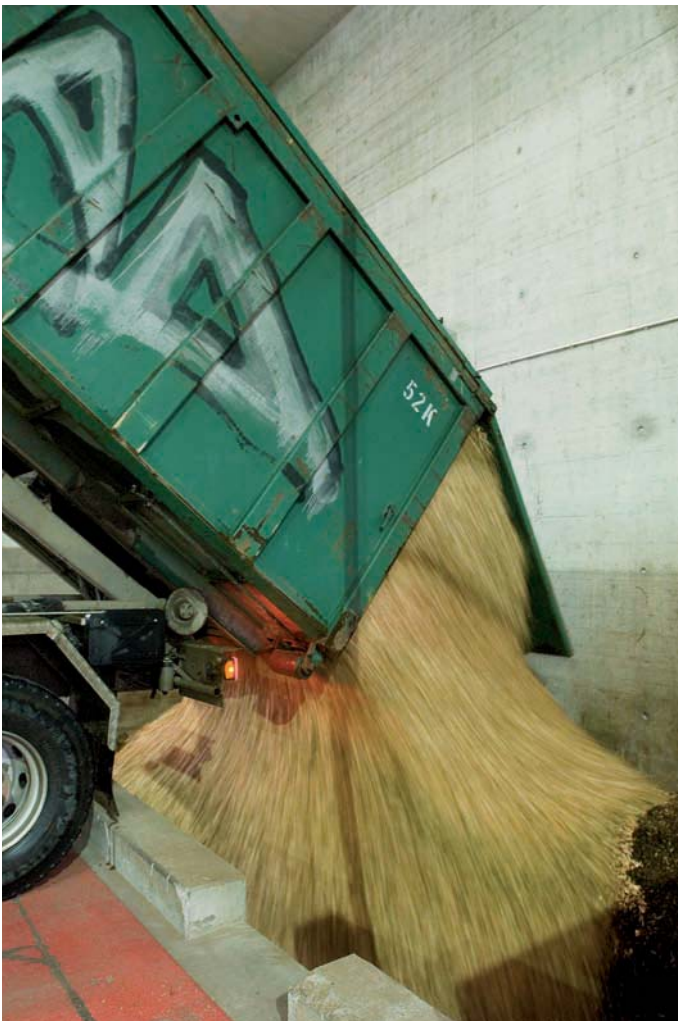
Holzchnitzel werden im Holzkraftwerk angeliefert.
